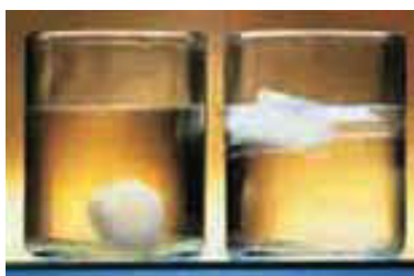
▲ Figura 11.9 En común con la mayor parte de las sustancias, la fase sólida de la parafina es más densa que la fase líquida, y por ello el sólido se hunde en el líquido (izquierda). En contraste, la fase sólida del agua, hielo, es menos densa que su fase líquida (derecha), y esto hace que el hielo flote en el agua. Richard Megna/Fundamental Photographs.
