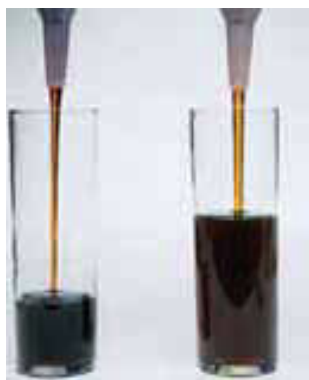
▲ Figura 11.13 La Sociedad de Ingenieros Automovilísticos (SAE) ha establecido números para indicar la viscosidad de los aceites para motores. Cuanto más alto es el número, mayor es la viscosidad a cualquier temperatura dada. El aceite para motor SAE 40 de la izquierda es más viscoso y fluye más lentamente que el aceite SAE 10, menos viscoso, de la derecha.
